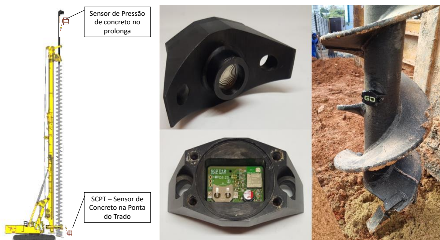
Figura 3. Posição dos sensores de concreto; sensor SCPT; sensor SCPT instalado no trado.
