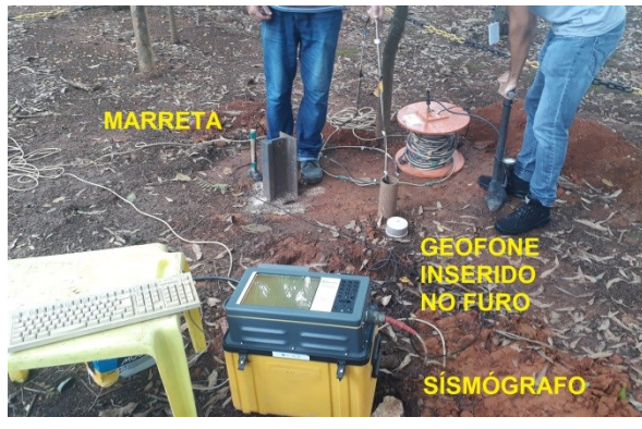
Figura 6. Ensaio Paralelo Sísmico realizado em campo.
