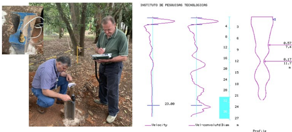
Figura 1. Realização do ensaio PIT mostrando no detalhe o acelerômetro colado na estaca metálica tipo trilho (esquerda). Exemplo de sinais de velocidade e perfil de impedância obtidos no ensaio PIT (direita).
