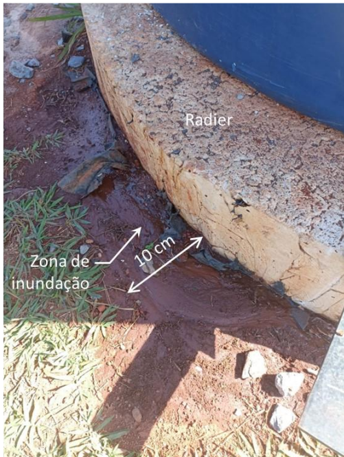
Figura 9. Zona de inundação observada na simulação física.
