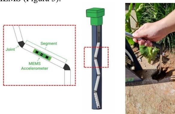
Figura 5. Shape Accel Array – Fonte: Autor
