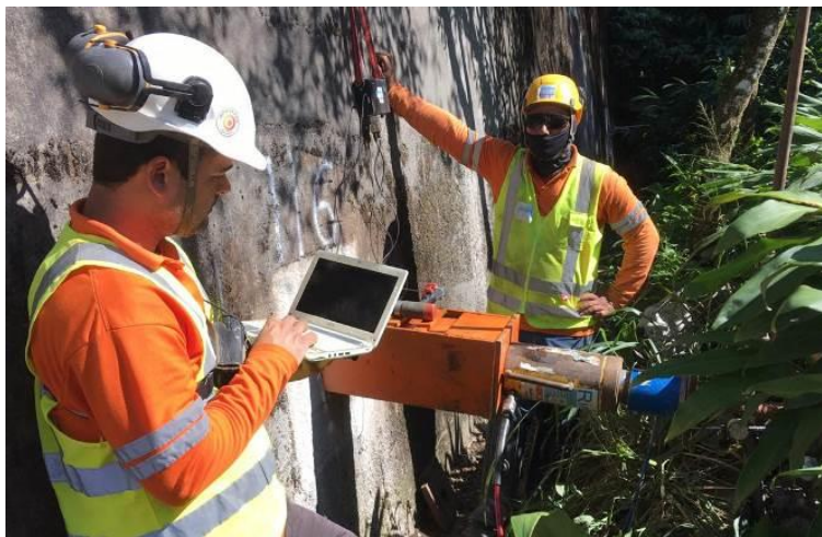
Figura 7. Realização do ensaio a Tração e dinâmico para Calibração.
