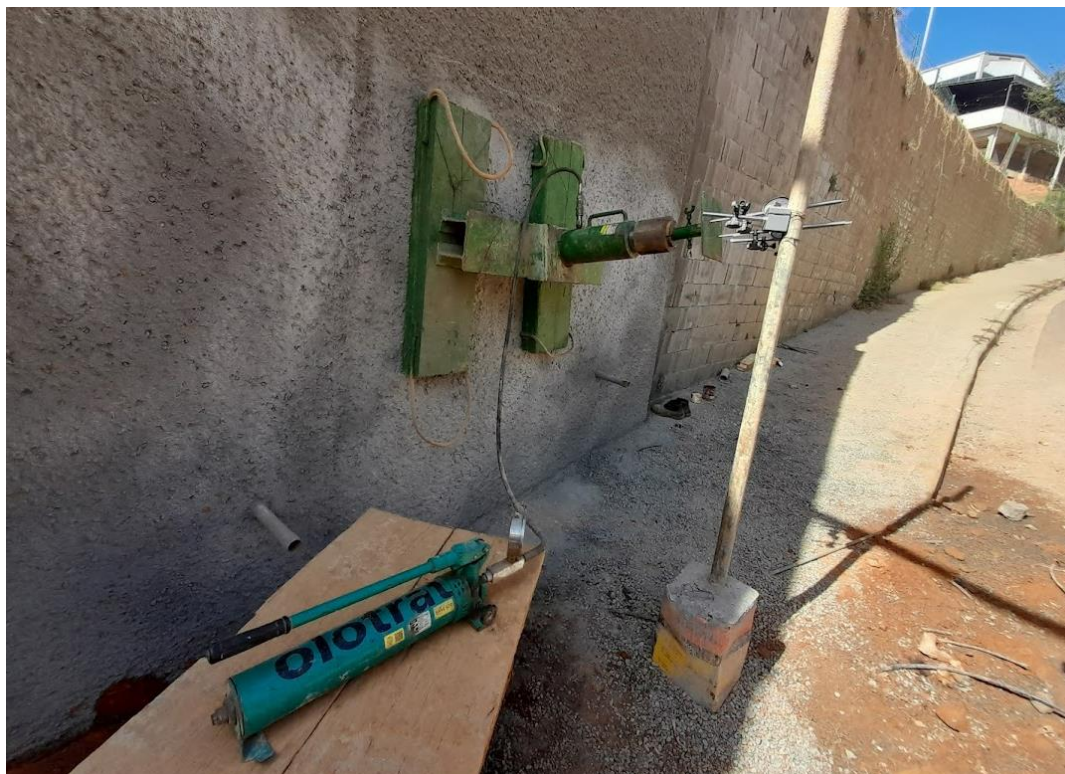
Figura 9 - Ensaio de arrancamento
