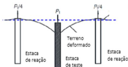
Figura 2. Esquema típico do ensaio. (ZHANG ET AL, 2013)
