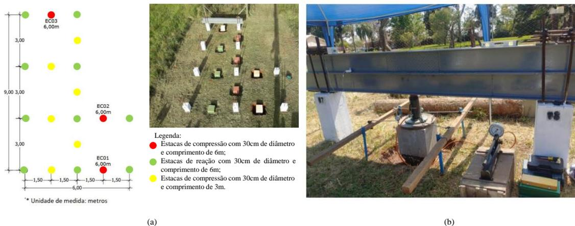
Figura 2. Disposição das estacas no campo experimental.
