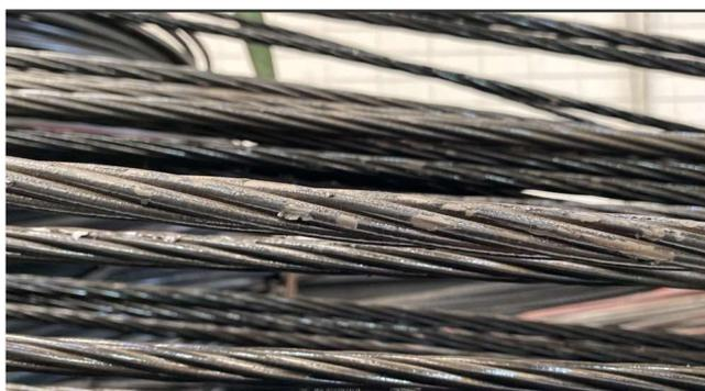
Figura 5. Cordoalha com sinais de pintura ineficientes.
