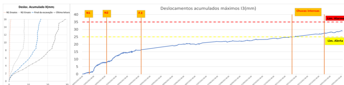
Figura 9 - a) Deslocamentos acumulados no inclinômetro I3. Curva de deslocamentos acumulados máximos com destaque para as instalações das ancoragens (N1, N2), final de escavação (F.E), período de chuvas intensas (nov/dez 22) e última leitura (jan/23) antes do início da estrutura.
