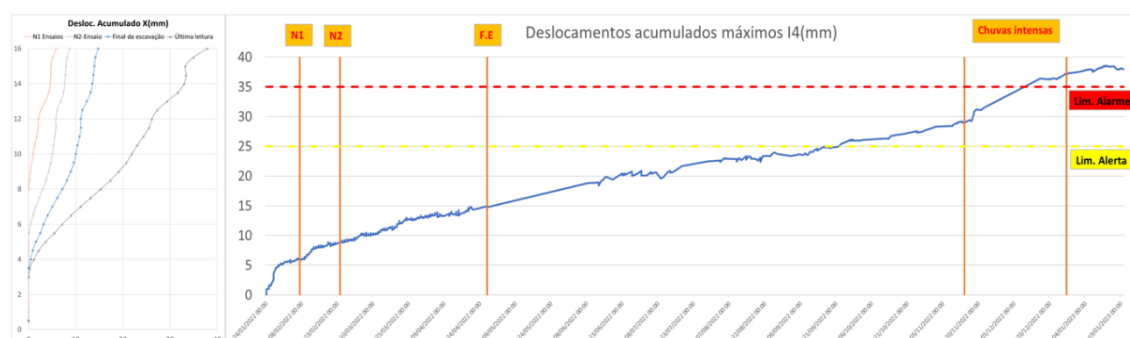
Figura 10 - a) Deslocamentos acumulados no inclinômetro I4. b) Curva de deslocamentos acumulados máximos com destaque para as instalações das ancoragens (N1, N2), final de escavação (F.E), período de chuvas intensas (nov/dez 22) e última leitura (jan/23) antes do início da estrutura.
