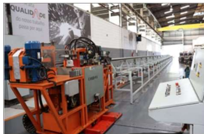
Figura 1. Máquina responsável pelo desbobinamento, corte dos cabos e preparação do trecho livre do tirante provisório.
