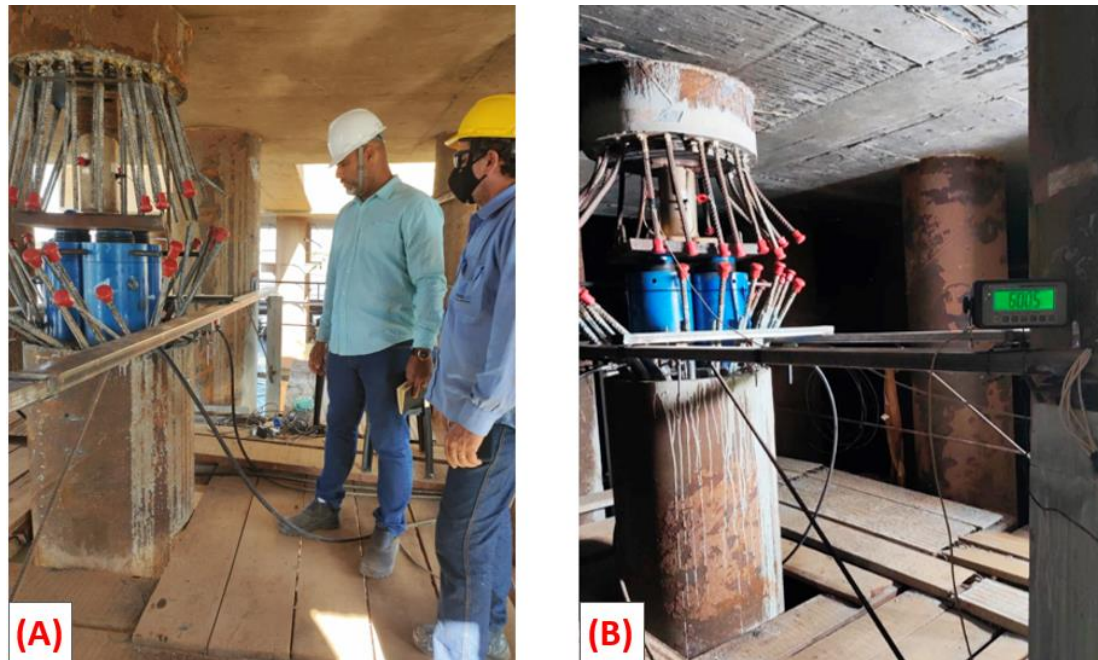
Figura 8. (A) Etapas de carregamento da PCE e (B) estabilização na carga máxima de 6000 kN.
