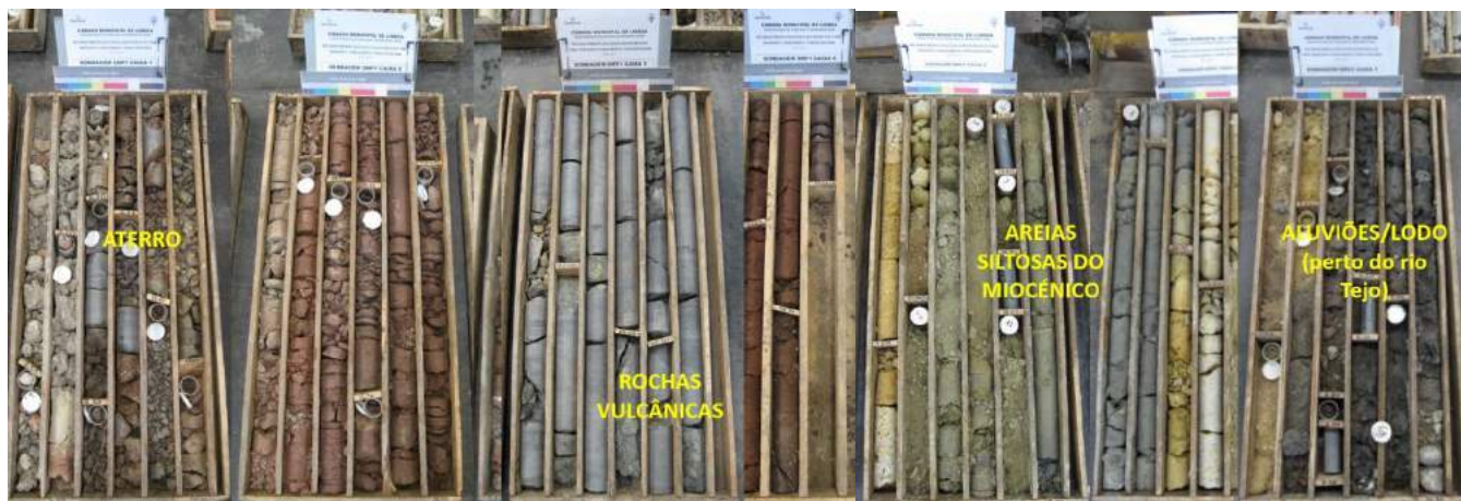
Figura 14 - Carotes retiradas das sondagens, com as diferentes camadas atravessadas, ao longo do traçado dos túneis (Fonte: LNEC, 2017)
