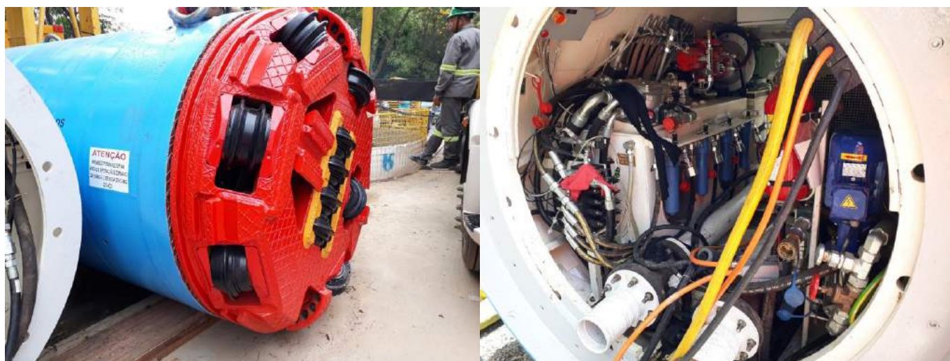
Figura 1 - Equipamento utilizado na escavação do túnel, vista da cabeça de corte (a) e interna (b). (Fonte: ATO GeoCompany)
