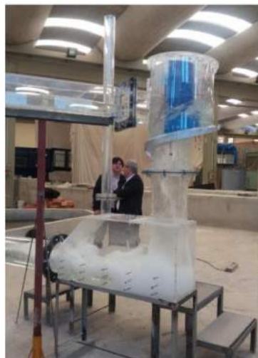
Figura 16 - Representação esquemática da queda em vórtice e modelo a escala reduzida realizado no LNEC (2017) (Fonte: EPPGDL)
