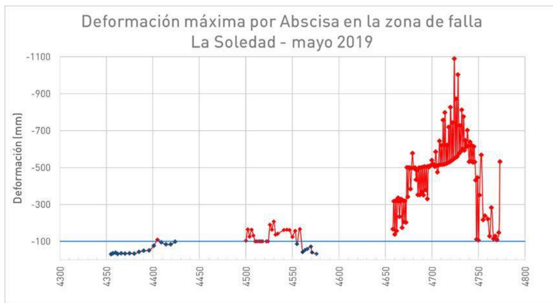
Figura 8 - Zona de Falla la Soledad – Gráfica general de deformaciones a mayo de 2019.
