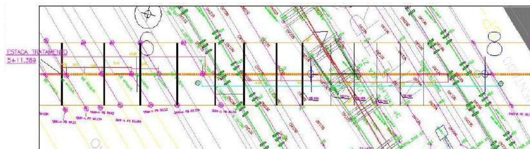
Figura 10 - Planta de localização dos marcos superficiais no trecho sobre os trilhos do metrô e da ferrovia - 2ª Etapa, Vallejos, D. 2018
