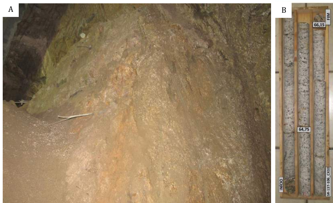
Figura 4 - Biotita granito, A) na frente de escavação em estado de solo de alteração de rocha (SAR) B) em sondagem realizada no projeto executivo, em estado são a praticamente são
