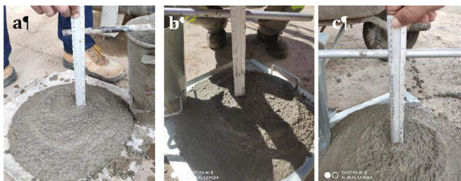
Figura 7 - Fornecedor 1. (a) Hiper=1,2% e 5 horas de manutenção - 235 mm. (b) Hiper=0,75% e 1 hora de manutenção - Slump 235 mm (c) Hiper=0,75% e 7 horas de manutenção - Slump 235 mm.
