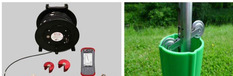
Figura 2 - Kit de inclinômetro e sistema de aquisição portátil (RST Instruments). Rodas autoajustáveis ao diâmetro do tubo.
