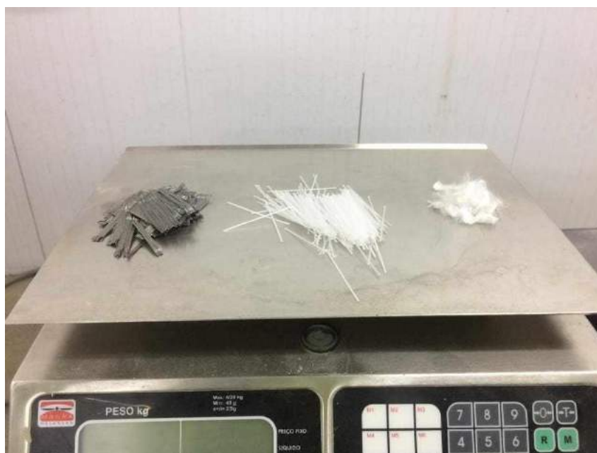
Figura 6 - Fibras de polipropileno à direita utilizadas nos traços de concreto projetado. Fonte: o Autor (2019).
