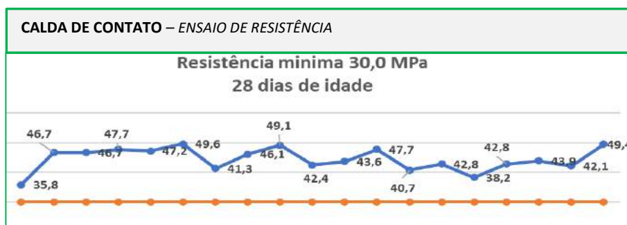
Figuras 3 a 8 - Resultados dos ensaios com os lotes de corpos de prova extraídos da estrutura
