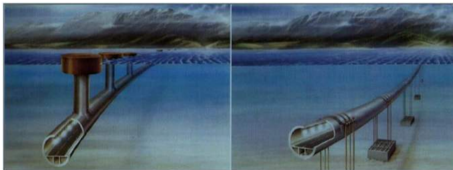
Figura 1 - Túnel flutuante com pontões (esquerda), e com esquema de âncoras (direita) Fonte: Jakobsen, 2010.
