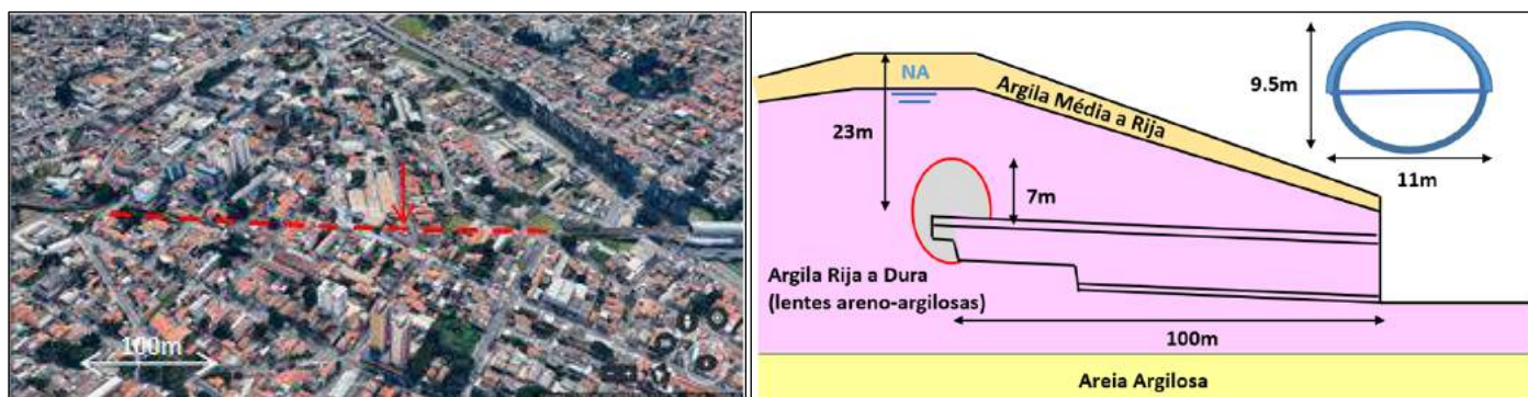
Figura 1 - Foto aérea à esquerda (fonte Google), com linha pontilhada representando o eixo do túnel e seta indicando a área colapso. Perfil simplificado do túnel, à direita.
