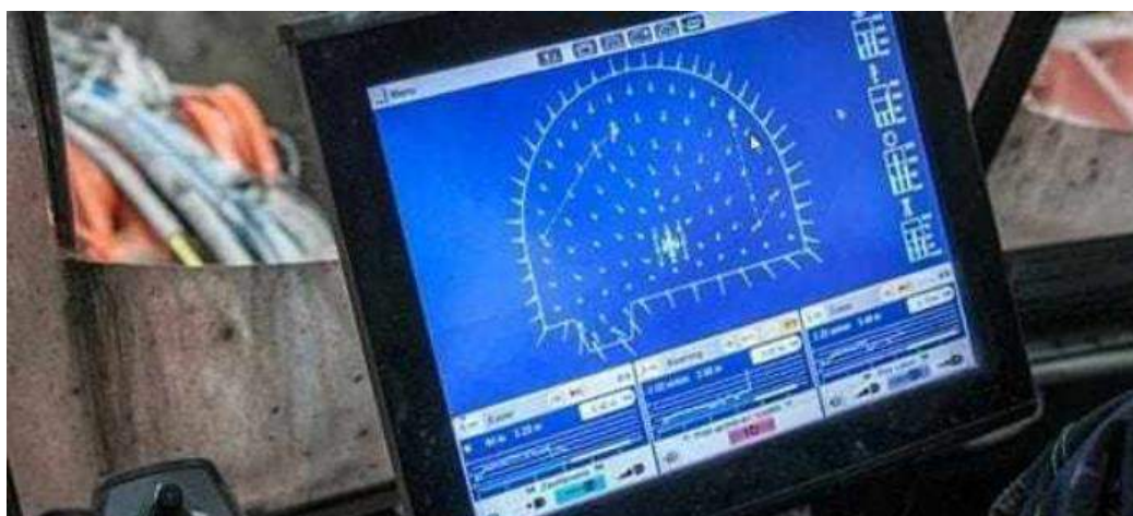
Figura 2 - Software T-CAD com o plano de fogo desenvolvido para uma determinada seção. Fonte: Manual Sandvik (iSURE™ SOFTWARE DRILL AND BLAST INTELLIGENCE).
