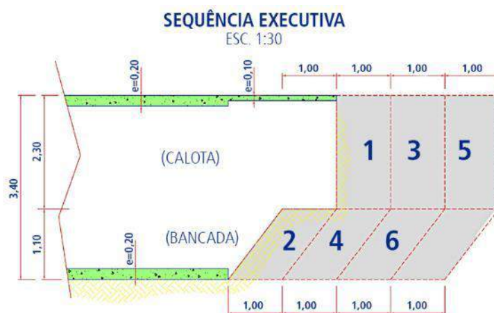
Figura 4 - Caso 10 – Sequência de escavação
