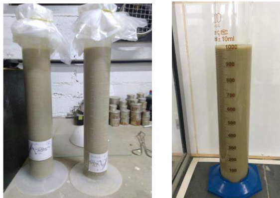
Figuras 09 e 10 - Ensaios de exsudação e densidade da calda (arquivo pessoal)
