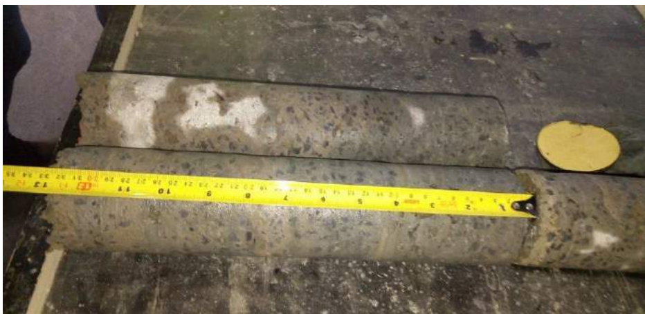
Foto 6 - Testemunhos (sem presença de armadura) extraídos da estrutura – camadas de concreto projetadas em malhas e em intervalo máximo de 72 horas
