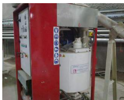
Figuras 05 e 06 - Silos de estocagem de calda ( slurry ) composta por bentonita e água e misturador, ambos no interior de túnel de apoio durante a execução da Linha 4 Sul do Metrô do Rio de Janeiro (arquivo pessoal)
