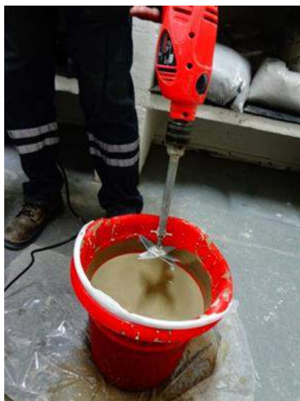
Figuras 07 e 08 - Mistura de calda de bentonita e água e ensaio de fluidez (RIVERA et al. , 2019)
