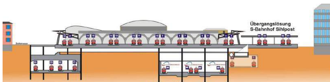
Figura 8 - Corte transversal com a implantação da nova estação Lowenstrasse sob a Estação Central de Zurique
