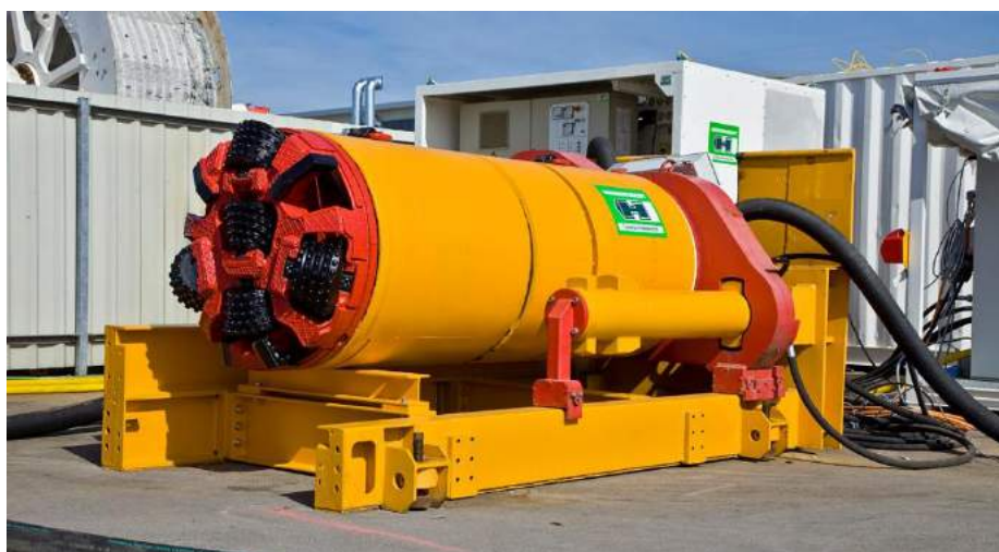
Figura 1 - Máquina AVN800 para rocha com discos de corte tipo TCI
