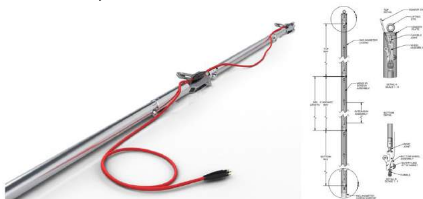
Figura 3 - Detalhe de conexão entre segmentos sensorizados de IPI e detalhe dos componentes
