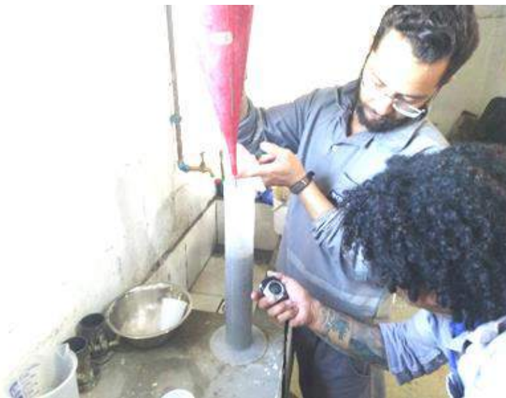
Figuras 07 e 08 - Mistura de calda de bentonita e água e ensaio de fluidez (RIVERA et al. , 2019)
